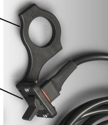
Il cablaggio del selettore termina con un connettore bianco, per collegarlo al PCV occorrerà tagliarlo ed inserire i due fili nelle posizioni 6 & 7 del PCV .
