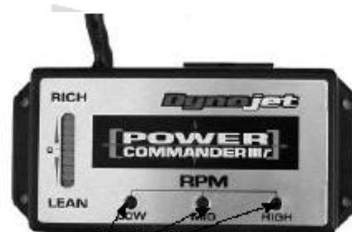
Per variare la carburazione del Power Commander premere contemporaneamente i tre pulsanti e avviare il motore.
